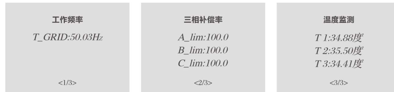
工作频率一般为电网频率50HZ；
