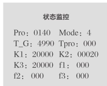
注：装置启动前检查状态监控数据需与图中数值相符。
