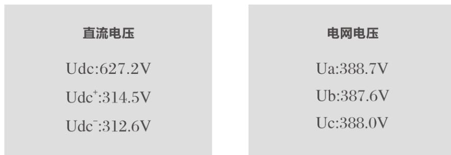
检查待机状态下总直流电压在600伏左右，正负直流电压300伏左右；电网电压380V左右。
