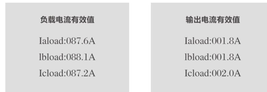
负载电流为实测数值，显示稳定即可，输出电流有效值为有源滤波模块输出的补偿电流，在装置未启动时基本为0。
